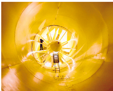
Im Windkanal wird Fahrtwind von bis zu 300 km/h erzeugt.
