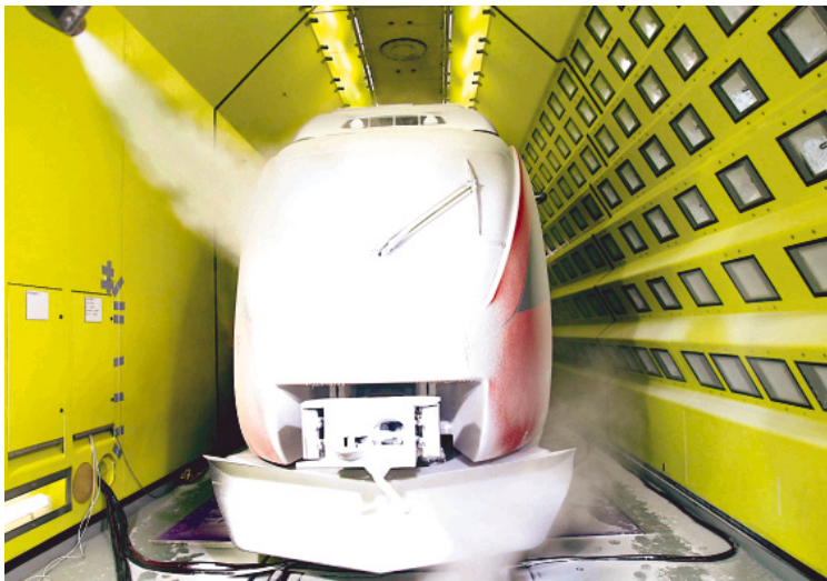
In der Klimakammer in Wien können Kälte und Eis ebenso erzeugt werden wie Sonnenhitze (mit den Lampen rechts).
